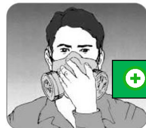
Figures 13 – Essais d'étanchéité à pression négative et à pression positive
